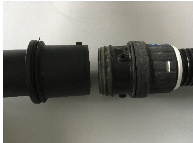
Bild 3: links: Anschlussmuffe Kärcher alt mit Rastnase, rechts: Kärcher neu mit drei Rastnasen und geänderter Ausbildung. [Walter Gunreben - BG BAU]
